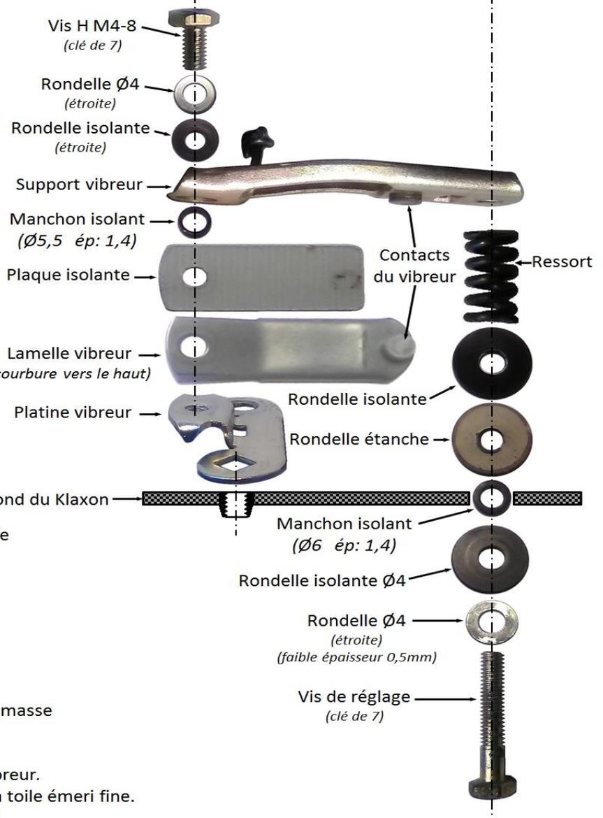
**Contrôle:** A l'ohmmètre, entre la cosse extérieur et la masse (vis de fixation du klaxon) valeur très faible  $\leq 1\Omega$
