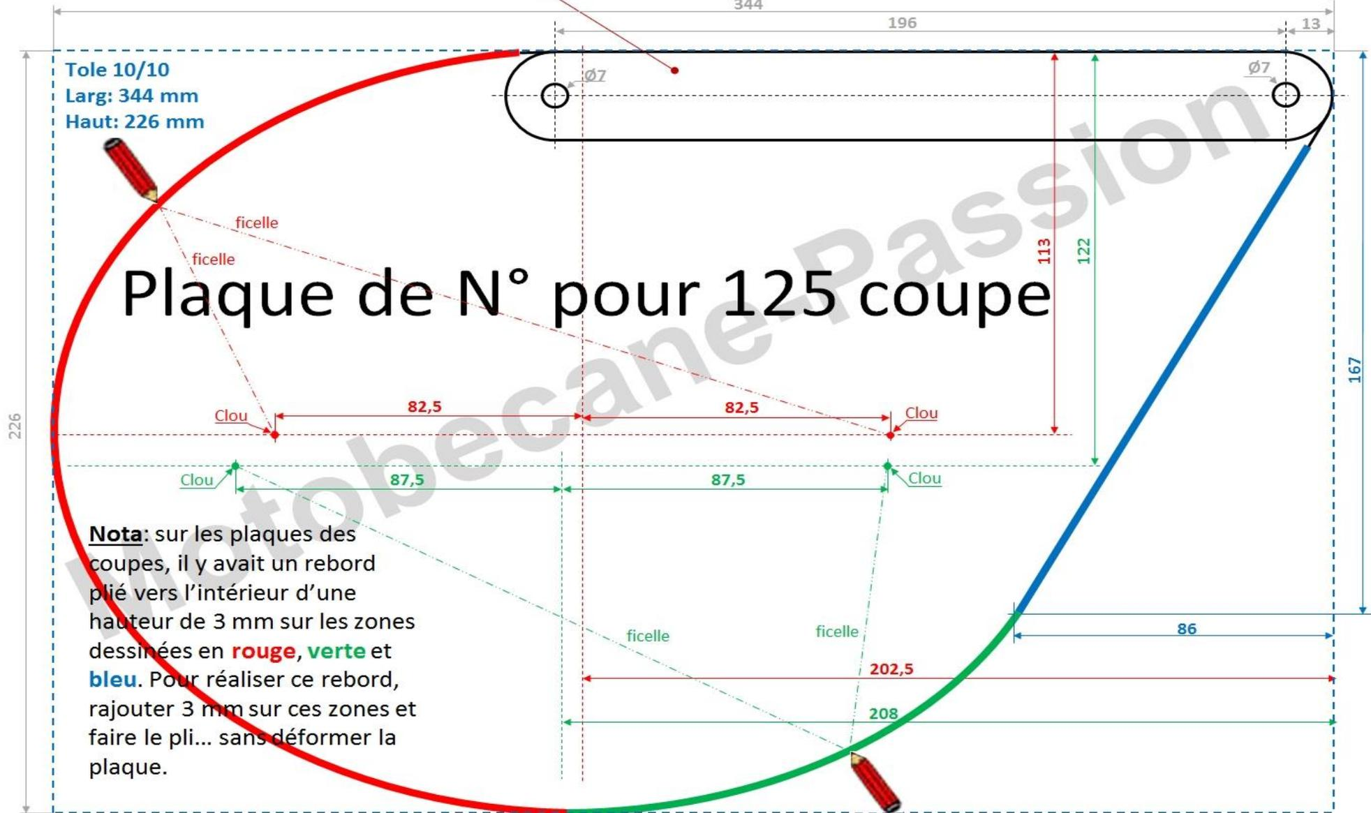
**Nota:** sur les plaques des coupes, il y avait un rebord plié vers l'intérieur d'une hauteur de 3 mm sur les zones dessinées en **rouge**, **verte** et **bleu**. Pour réaliser ce rebord, rajouter 3 mm sur ces zones et faire le pli... sans déformer la plaque.
