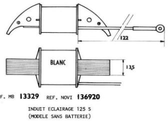
Prochainement nos inducts seront fournis avec un fil de sortie de longueur 90. Cet induct remplace le premier modèle longueur 122. Dans le cas d'utilisation de ce dernier modèle (long. 90) il est nécessaire de surélever le self à l'aide de 2 rondelles d'épaisseur 2 pour permettre le passage sous cette même self, du fil de raccordement à la plaque à bornes.
