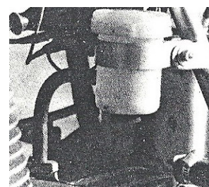
Le flacon destiné à recevoir l'huile provenant du reniflard de boîte
